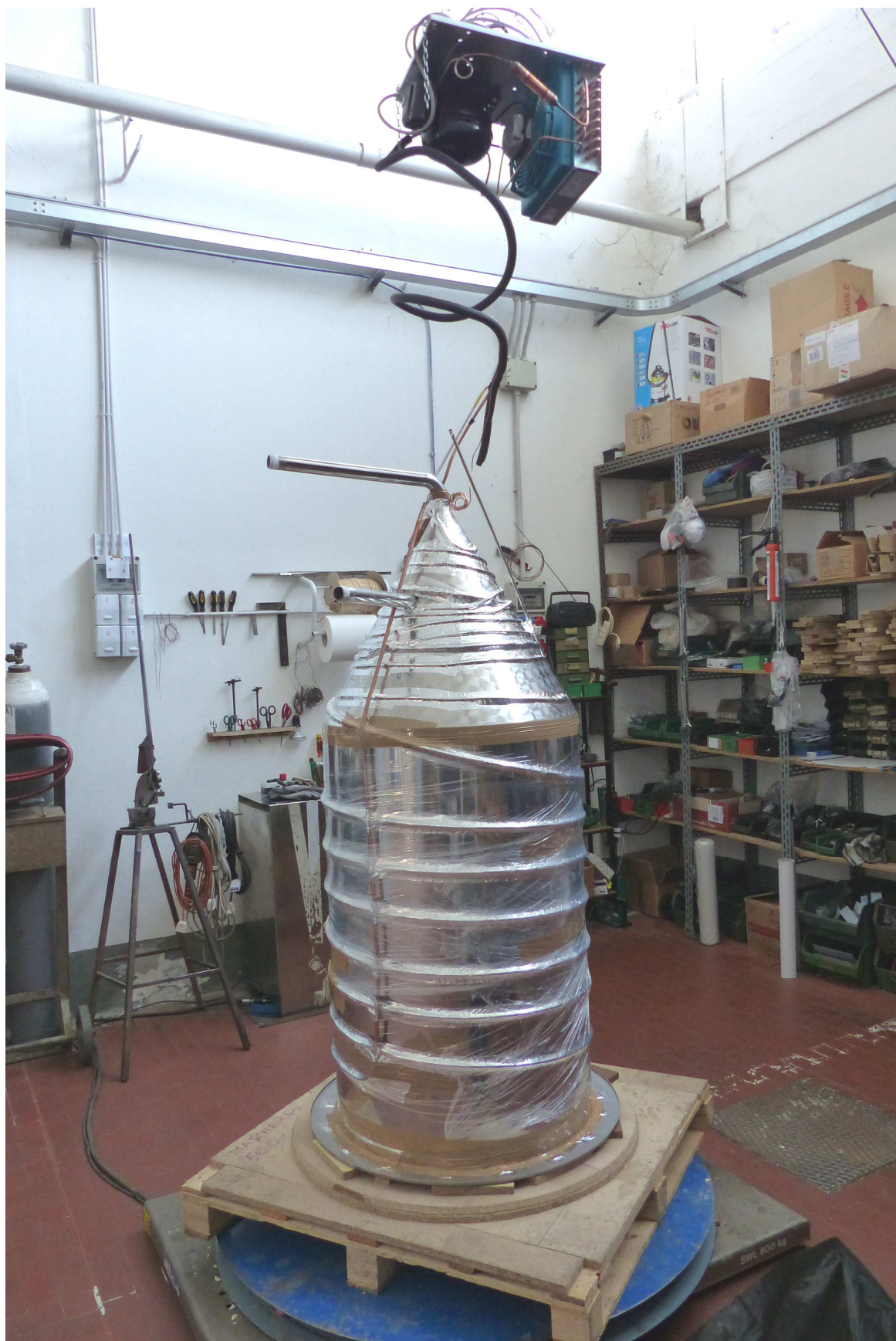
Fase di montaggio di un serbatoio refrigerato con fondo conico 60°
